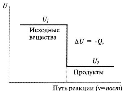
Рис. 3-3. Энергетическая диаграмма реакции при постоянном объеме
